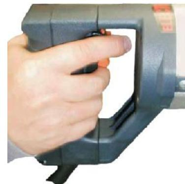
Если сверление выполняется на станине, черную клавишу включения питания можно зафиксировать в нажатом положении. Для этого при нажатой клавише необходимо нажать блокиратор большим пальцем. Теперь для остановки бормотора необходимо нажать, и затем отпустить черную клавишу.
