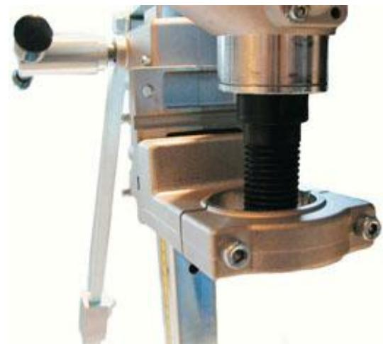
Для использования бормотора со станиной вставьте шейку бормотора в хомут станины и затяните болты хомута.
